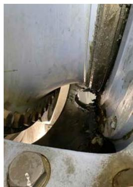
Rotorlager-Anomalie, vom Turbit-System erkannt
