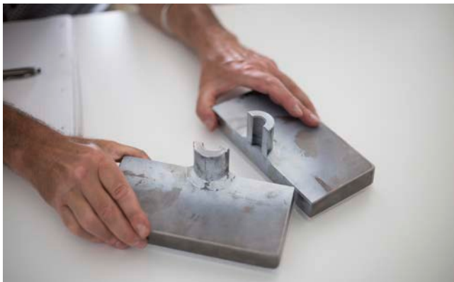
Anschweißkonstruktion für Turmeinbauten im Modell von PE Concepts
