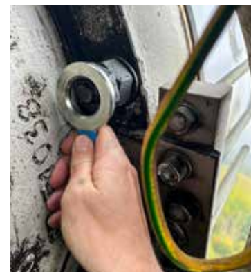
Aufbau der Identiflight-Kameratechnik links und oben. Bolzensensorik von Altosens in den Unterlegscheiben (unten Mitte und rechts)
